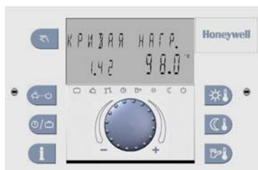
Задана кривая 1.42, т.о. температура воды будет 98 °С при уличной температуре -35 °С
